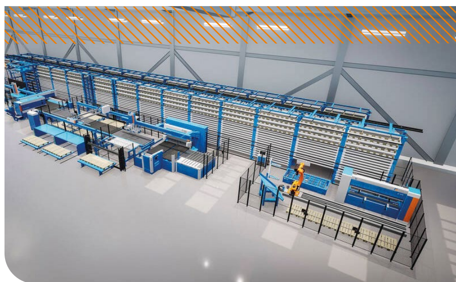
Eine flexible, fabrikweite automatische Lösung mit einzelnen Blöcken, die in verschiedenen Schritten hinzugefügt werden können
