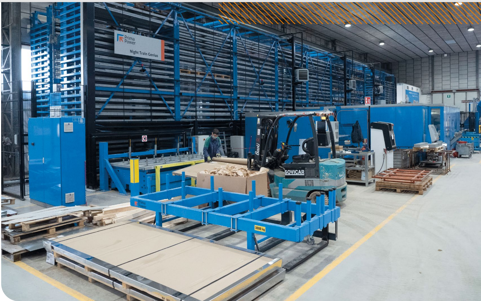
Das automatische Lager Night Train ist mit der Shear Genius und der Roboter-Biegezone verbunden, die aus einer Fast Bend Schwenkbiegemaschine und einer eP 1030 Abkantpresse besteht.
