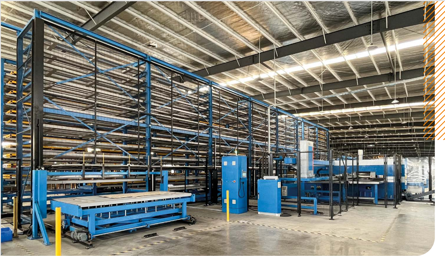
Die in Zhilai installierte Produktionslinie von Prima Power ist mit dem automatischen Lager Night Train FMS® verbunden.
