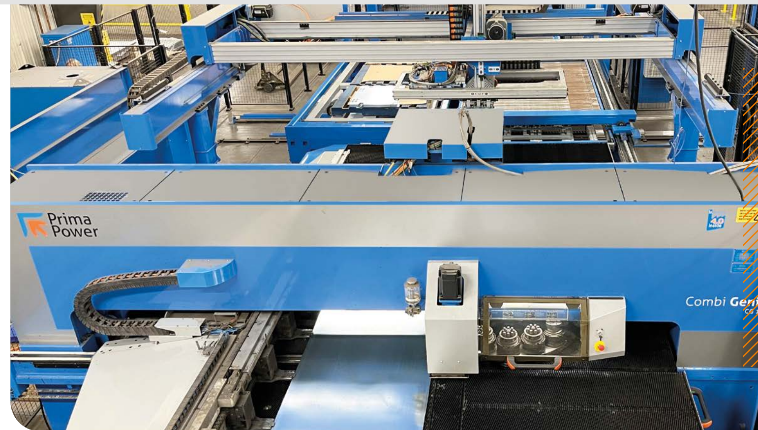
La cella integrata di punzonatura e taglio laser Combi Genius combina la tecnologia servo elettrica e il laser fibra in una soluzione automatizzata veloce e precisa con un'unica configurazione.
