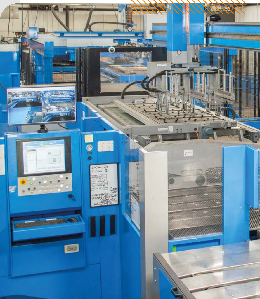
La linea produttiva LPBB di Prima Power integra il taglio laser, la punzonatura, la piegatura e la gestione intelligente dei pezzi.
