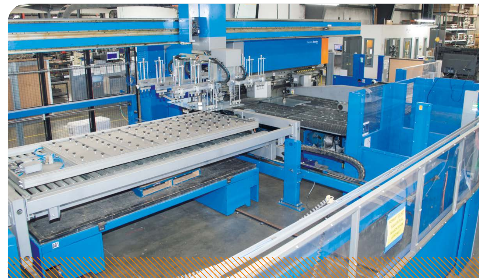
L'aumento di produttività della pannellatrice servo elettrica si avvicina al 500-600% rispetto alla pressa piegatrice.
