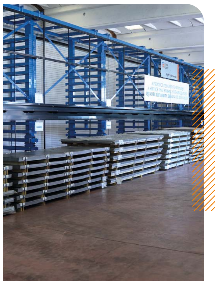
Per il suo nuovo impianto di produzione, DEA+RO&Co ha scelto una linea LPBB (Laser, Punching, Buffering, Bending) integrata con una soluzione di immagazzinamento Night Train FMS.
